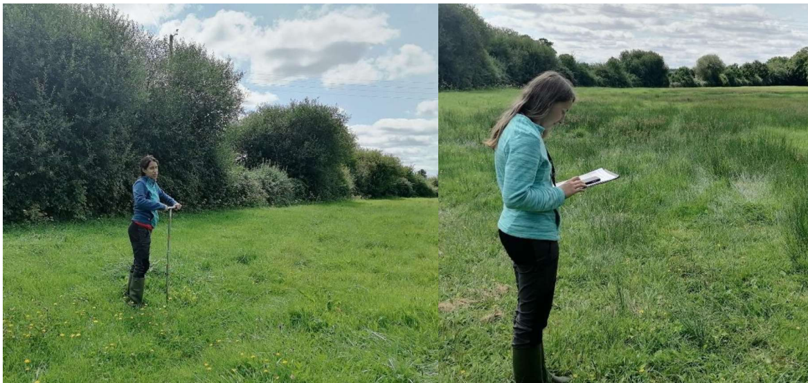
Figure 2: Prospection dans le cadre de la réalisation d'un inventaire de zone humide intercommunal : sondage pédologique, caractérisation et usage de la saisie sur tablette (DCI Environnement)
